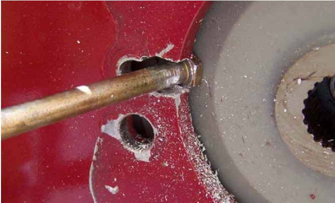
A slot to remove long bolt.
