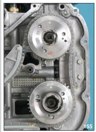
LEFT BANK CAMSHAFT AT 12:00 O'CLOCK POSITION
