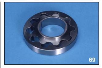
PUMP GEARS (BACK SIDE)
