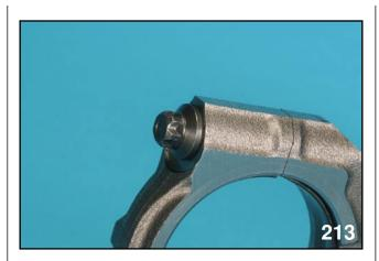
CONNECTING ROD CAP SEAM
