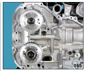
INTAKE SPROCKET ARROWS 12:00 O'CLOCK
