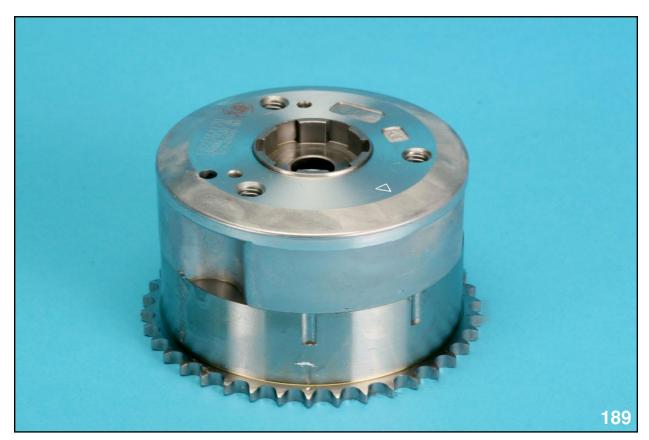
INTAKE CAMSHAFT SPROCKET
