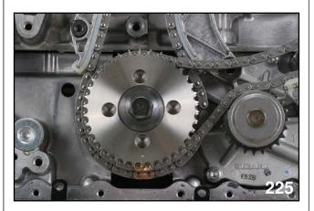
CHAIN DRIVING WATER PUMP SPROCKET
